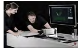
LAB SCAN Dicke/Gewicht. Prüfmuster bis 200 x 450 mm.
